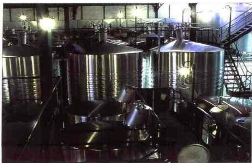
波米瑞(Pommery)的不锈钢发酵罐
