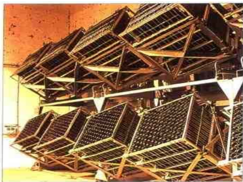
比耶卡尔·萨尔蒙(Bilecart-Salmon)的旋转操作板(自动集中沉淀装置)
