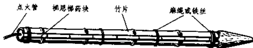
图 4—49 用竹材捆包的直列装药
