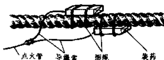
图 6—14 用两个集团装药炸断钢索
