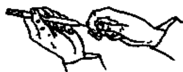
图 3—3 用拉火管点燃导火索
