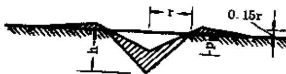
图 5—5 抛掷漏斗坑可见深度
