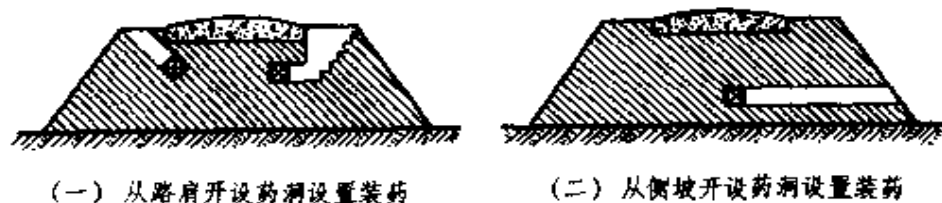
图 8—1 爆破填土路基的装药
