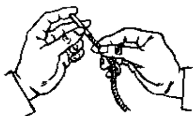
图 3—1 将导火索插入火雷管内
